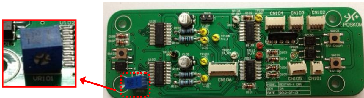
<Рис. 3.1.3.4 Расположение переменного резистора для калибровки нити накаливания>
