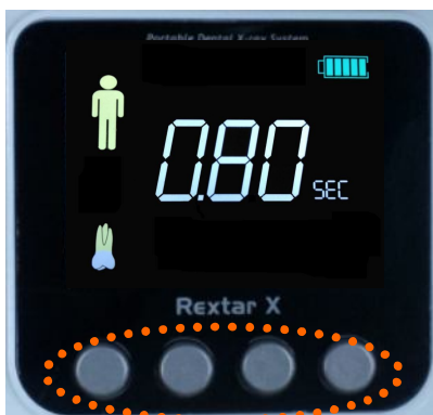
< Рис. 1.9.5.1 Старт РЕЖИМА УСТАНОВКИ функции АПР >
